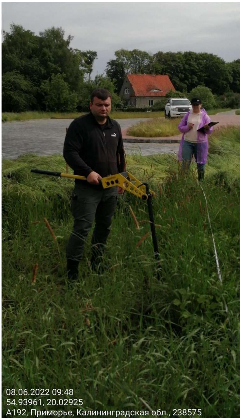
Рисунок 61 - замеры на КУ-1 08 июня 2020 г. оператором Дементьевым Н.Ю. аппаратурой FERX 4.032.API в присутствии представителя Заказчика – главного инженера проекта Т.В. Ивановой.
