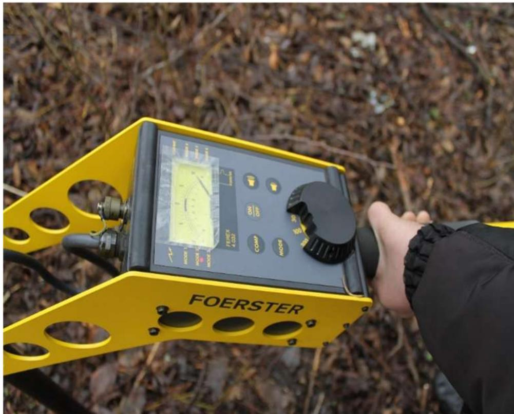
Рисунок 55 - индикатор FEREX фиксирует максимум аномального (протяженного) магнитного поля. Точность 2-3см. Стрелка сильно отклонена вправо.
