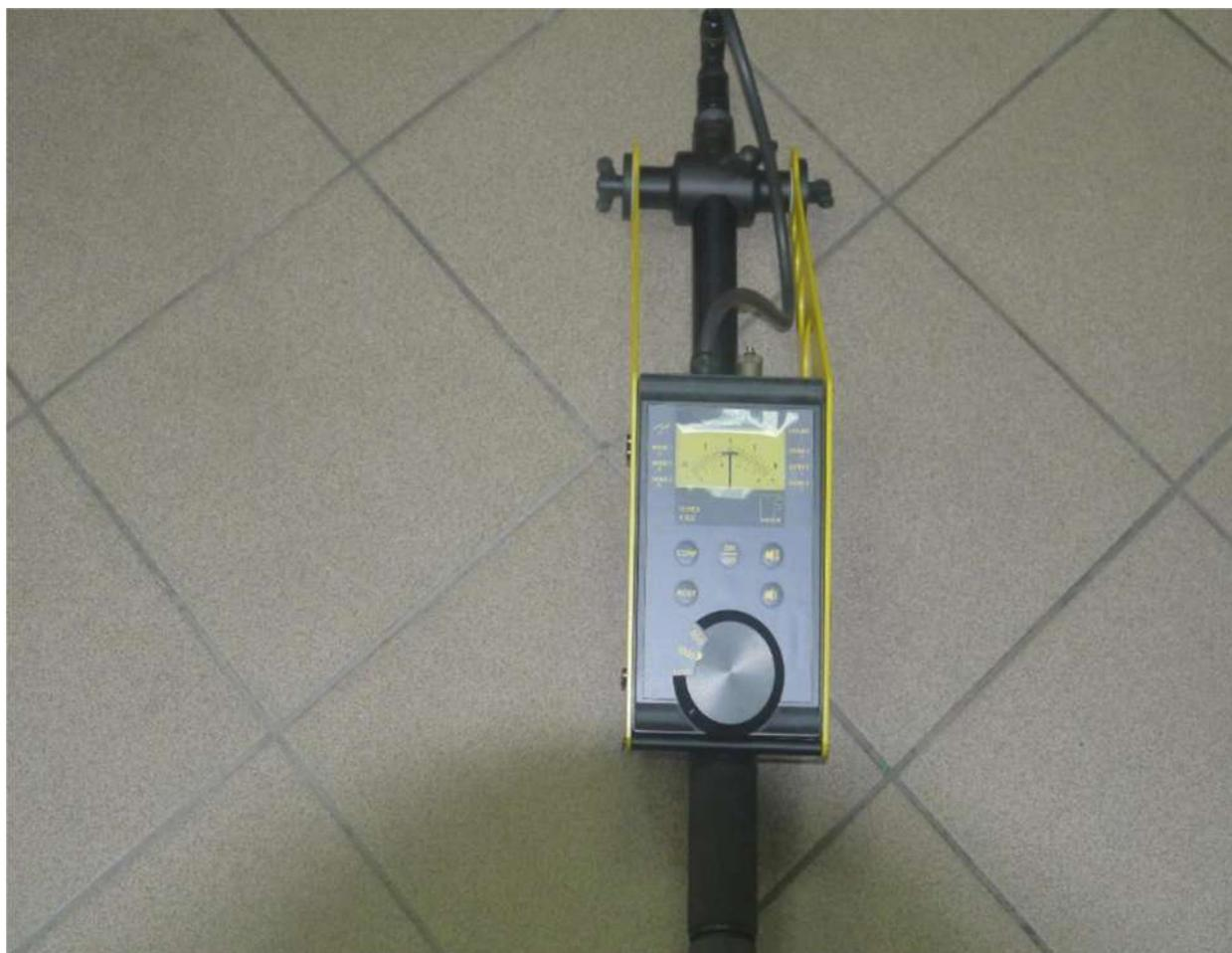
Рисунок 57 - дисплей аппаратуры FEREX 4.032 API.
