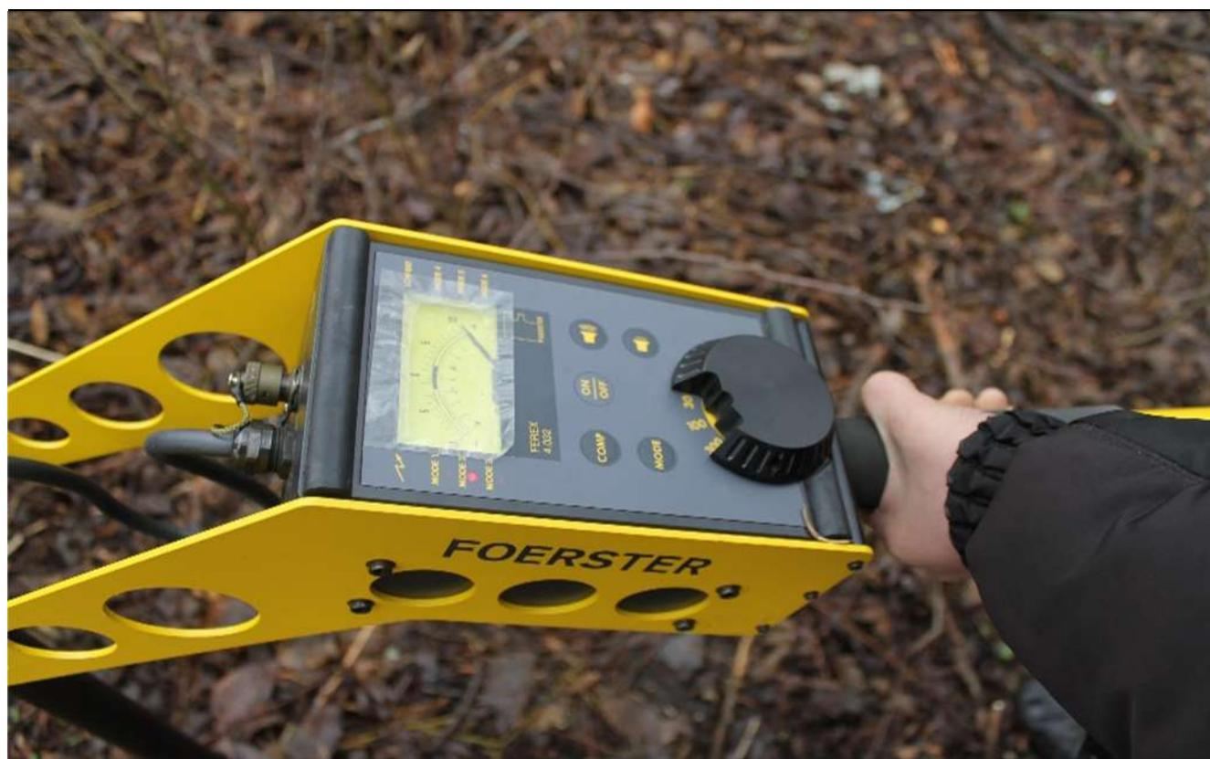
Рисунок 58 - отклонение стрелки ферроградиентометра, когда приемная антенна аппаратуры находится точно над максимумом поля магнитной аномалии.
